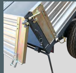
Hintere Rückwand mit Pendelverschluß und Eckstehern (nicht beim E15).
