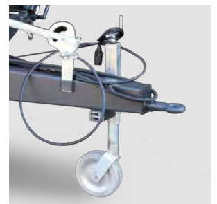
Höhenverstellbares Stützrad. Optional für E15 bis E35, Serie bei E52 und E62.
