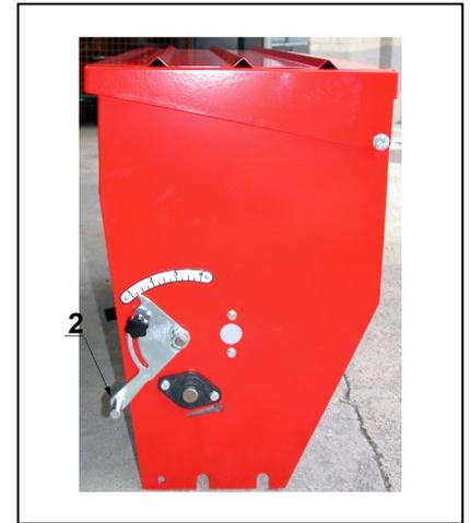
Um die Saatgut aus dem Trichter zu laden, bewegen Sie den Hebel "4" aus Position C in Position "A". Nach dem die Saat ausgeladen wurde, der Hebel "4" wieder in Stellung "C" bringen.
